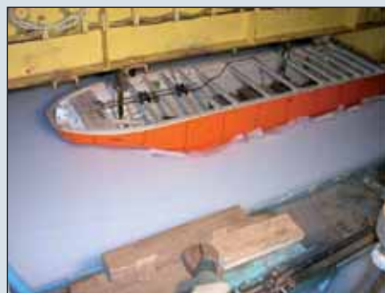
Буксировочные испытания ледокольного судна в ровном льду
