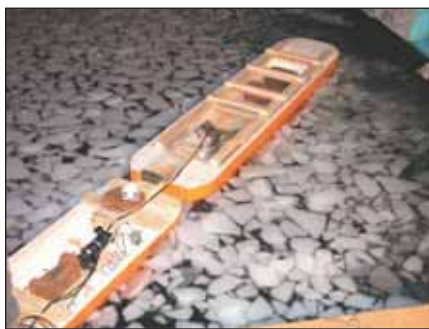
Самоходные испытания сцепки баржа-буксир в битом льду
