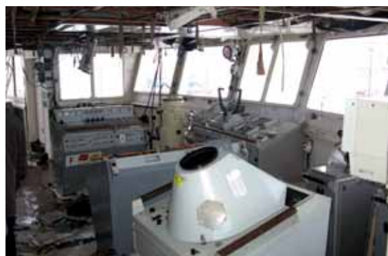
Уйти к берегу «Капитан Кузнецов» не успел – судно столкнулось с 10-метровой волной, которая обрушилась на носовую часть и повредила управление в рулевой рубке
