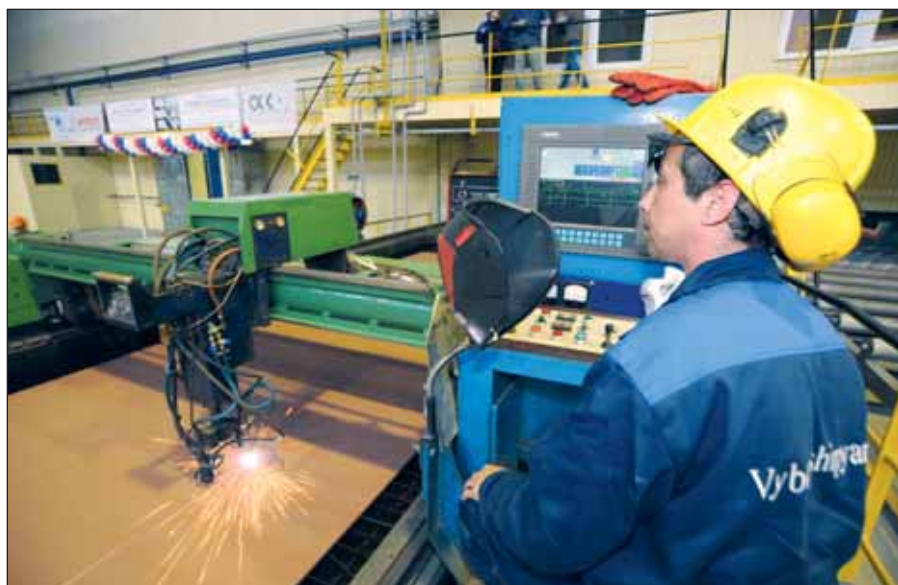
Резка стали для первого ледокола-снабженца добывающих платформ на Выборгском судостроительном заводе
