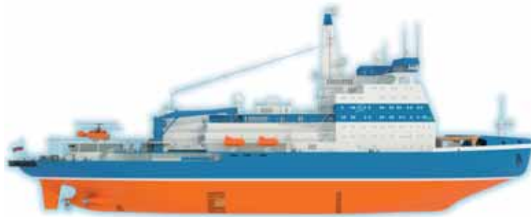
Схема общего расположения атомного ледокола мощностью 60 МВт
