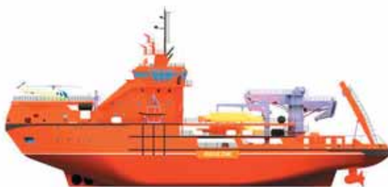
Вид аварийно-спасательного судна ледового класса Arc5 мощностью 7 МВт
