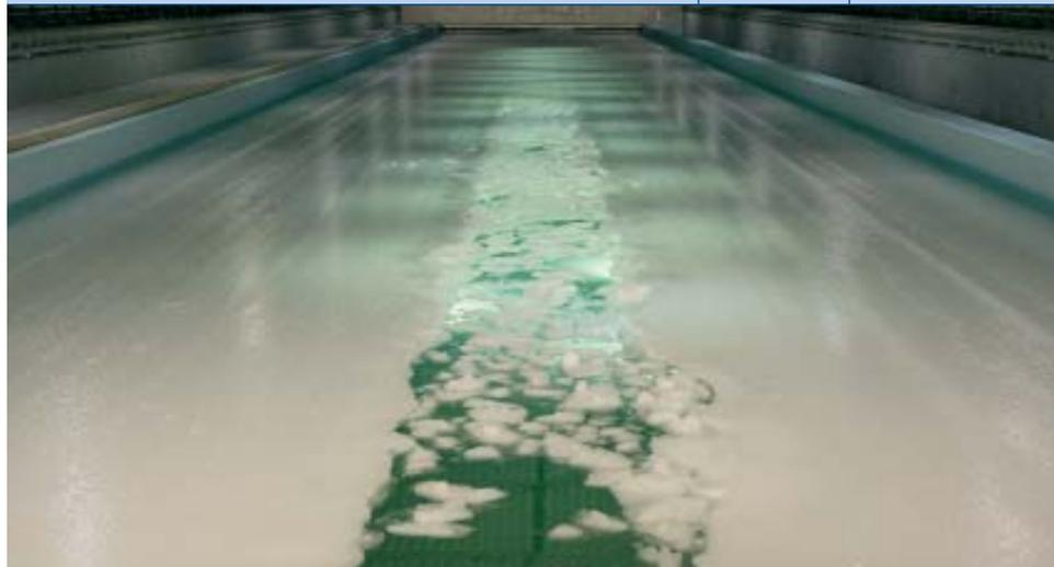
Рис.1. Вид на поле моделированного гранулированного льда в чаше нового ледового бассейна
