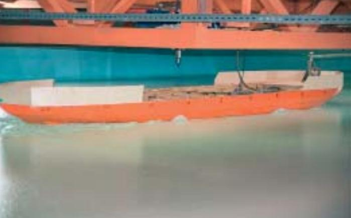
Рис.2. Проведение модельных испытаний ледокола в новом ледовом бассейне
