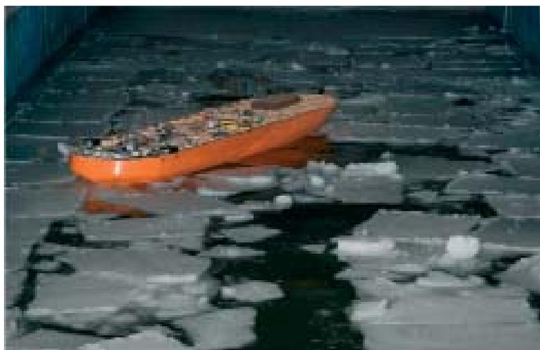
Рис.3. Отработка комплекса физического моделирования управления ледовой обстановкой на модели ледокола в ледовом бассейне
