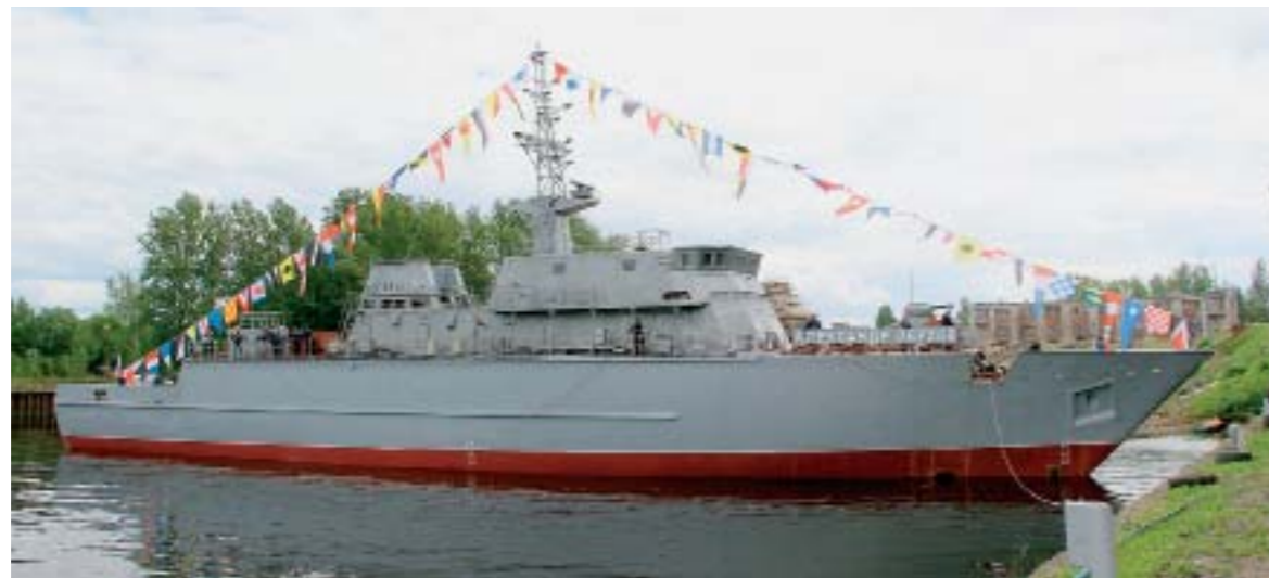
Минный тральщик проекта 12700 «Александрит» имеет полностью композитный корпус
