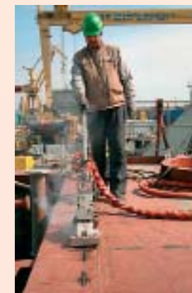
Система Teras производства EFD Induction обеспечивает четкую воспроизводимость циклов нагрева, а также безаварийную работу, не допуская перегрева магнитной стали.
