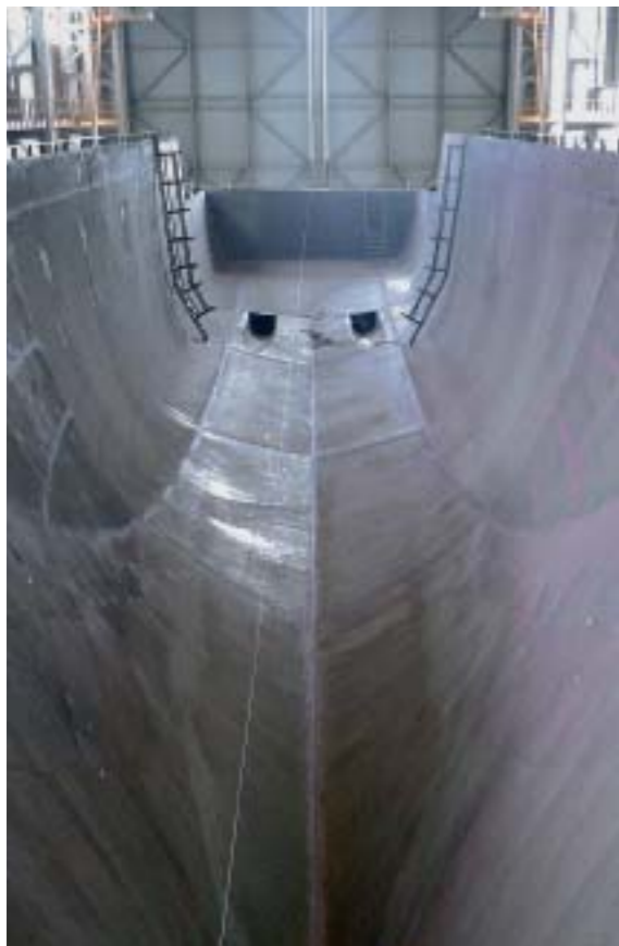
Универсальная матрица для производства композитных корпусов современных минных тральщиков
