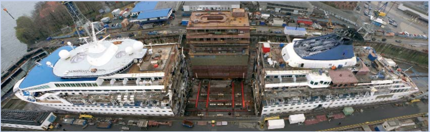
Удлинение корпуса круизного лайнера на 30 м за 70 дней
