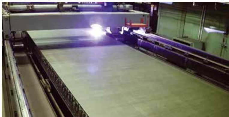
Резка металлического листа для траулера пр. 170701 на Северной верфи
