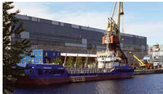
Грунтоотвозная шаланда «Сильная» пр. НВ 600 – первое в мире судно с вентильным дизель-генератором переменной частоты вращения.
