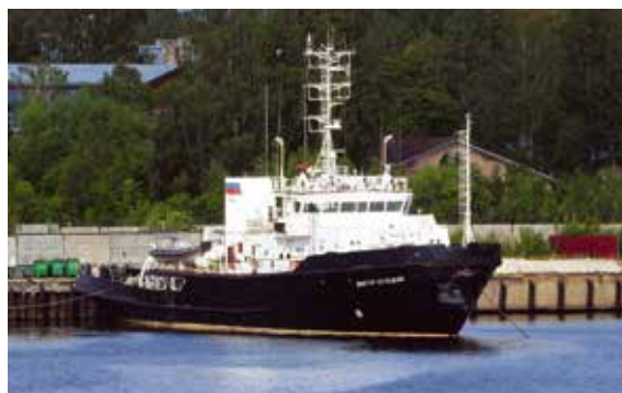
Морской буксир-спасатель «Виктор Коневский» пр. 745МБ - первое судно в мире с вентильным гребным электродвигателем переменного тока
