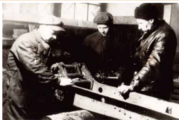
Сборка лафета 76-мм пушки на Балтийском заводе
