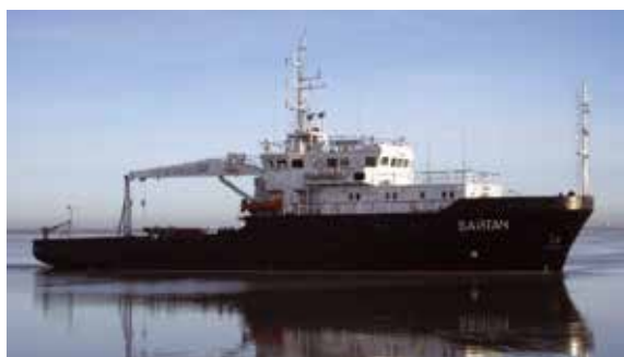
Малое гидрографическое судно «Вагач» пр. 19910 - первое отечественное судно с единой электроэнергетической системой и гребной электрической установкой переменного тока
