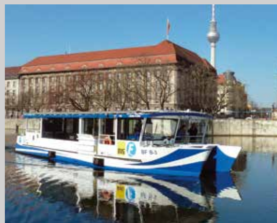
Прогулочный алюминиевый катамаран (построен в 2015 г.) Основные характеристики: вместимость - 60 сидячих мест; электродвигатели - 2х15 кВт; литий-полимерные АКБ; солнечных панели - 52 шт.; длина - 18,50 м; ширина - 5,40 м; осадка - 0,63 м; высота - 3,25 м; скорость рабочая - 8 км/ч, скорость максимальная - 15 км/ч.
