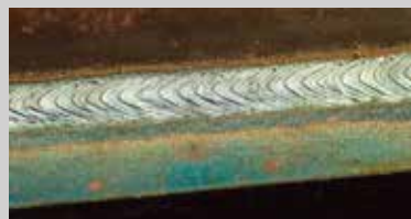
Рис. 3. В диапазоне полукруглой дуги процесса WiseSteel производится чередование переноса по короткой дуге и струйного переноса. Это приводит к образованию чешуйчатой поверхности сварного шва
