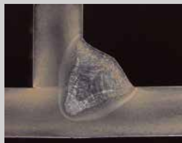
Рис. 5. Горизонтально-вертикальный шов шестимиллиметрового листа с использованием процесса WiseSteel и дуги со струйным переносом материала
