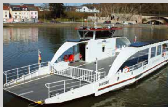
Прогулочный алюминиевый катамаран (построен в 2015 г.) Основные характеристики: вместимость - 60 сидячих мест; электродвигатели - 2х15 кВт; литий-полимерные АКБ; солнечных панели - 52 шт.; длина - 18,50 м; ширина - 5,40 м; осадка - 0,63 м; высота - 3,25 м; скорость рабочая - 8 км/ч, скорость максимальная - 15 км/ч.
