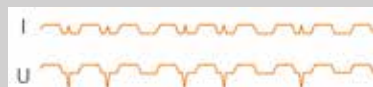
Рис. 4. Микропульсация для диапазона сварки со струйным переносом материала в процессе WiseSteel. Острые пики тока и напряжения соответствуют коротким замыканиям, вызываемым небольшой длинной дуги
