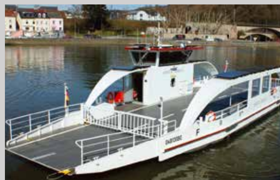
Прогулочный алюминиевый катамаран (построен в 2015 г.) Основные характеристики: вместимость - 60 сидячих мест; электродвигатели - 2x15 кВт; литий-полимерные АКБ; солнечных панели - 52 шт.; длина - 18,50 м; ширина - 5,40 м; осадка - 0,63 м; высота - 3,25 м; скорость рабочая - 8 км/ч, скорость максимальная - 15 км/ч.
