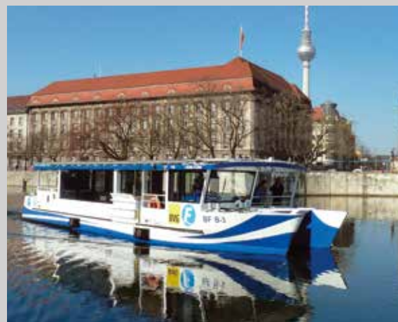
Прогулочный алюминиевый катамаран (построен в 2015 г.) Основные характеристики: вместимость - 60 сидячих мест; электродвигатели - 2x15 кВт; литий-полимерные АКБ; солнечных панели - 52 шт.; длина - 18,50 м; ширина - 5,40 м; осадка - 0,63 м; высота - 3,25 м; скорость рабочая - 8 км/ч, скорость максимальная - 15 км/ч.
