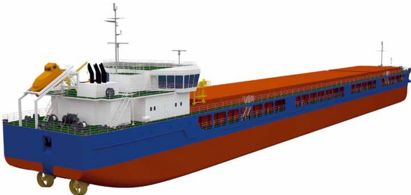
Сухогруз проекта RSD59 на Окской судовой верфи станет первым, построенным в РФ судном в соответствии со стандартом TIER III
