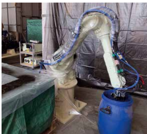
Установка для роботизированного напыления HiStream Spray. Фото: «Регент Балтика»
