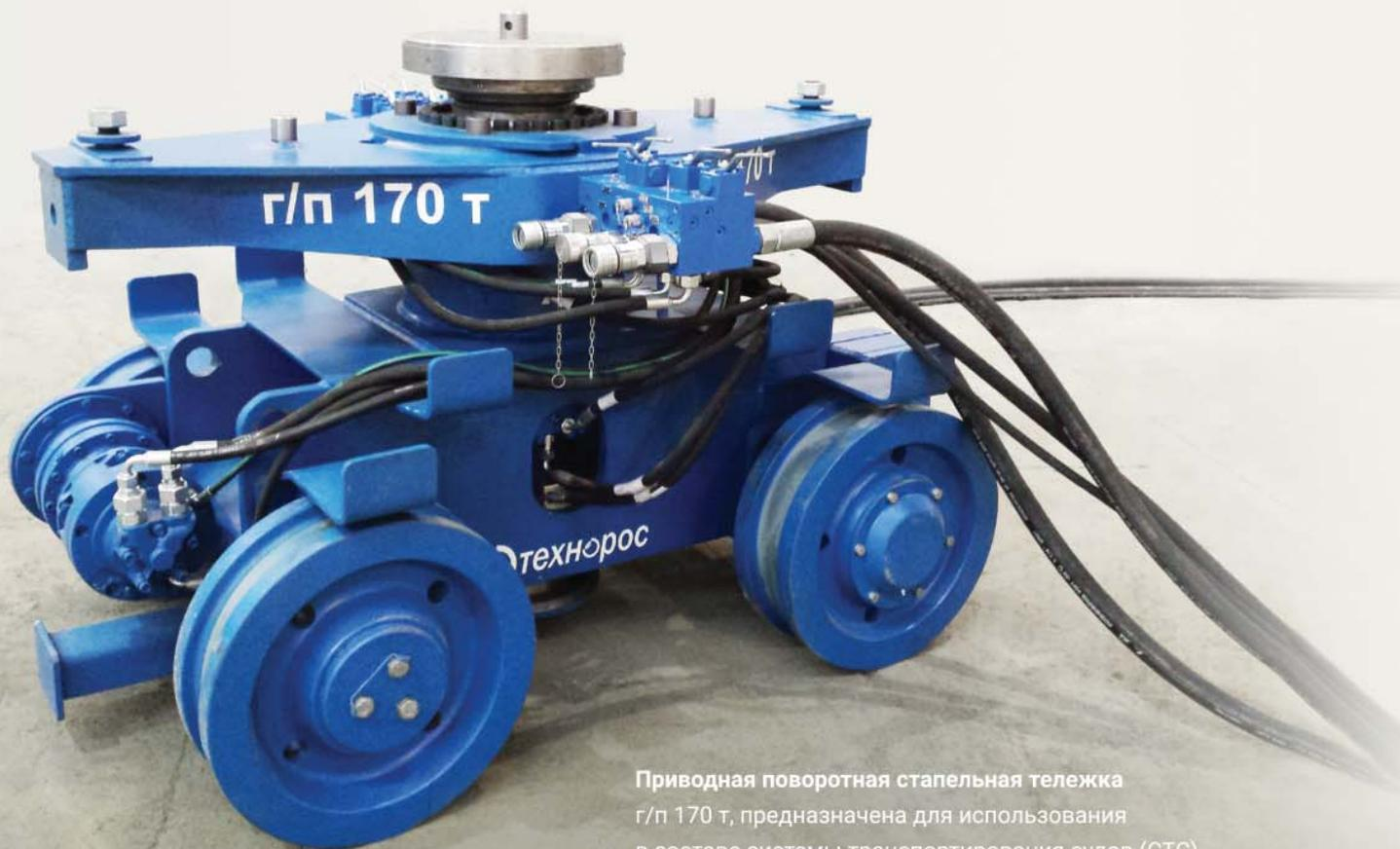
Приводная поворотная стапельная тележка г/п 170 т, предназначена для использования в составе системы транспортирования судов (СТС)
