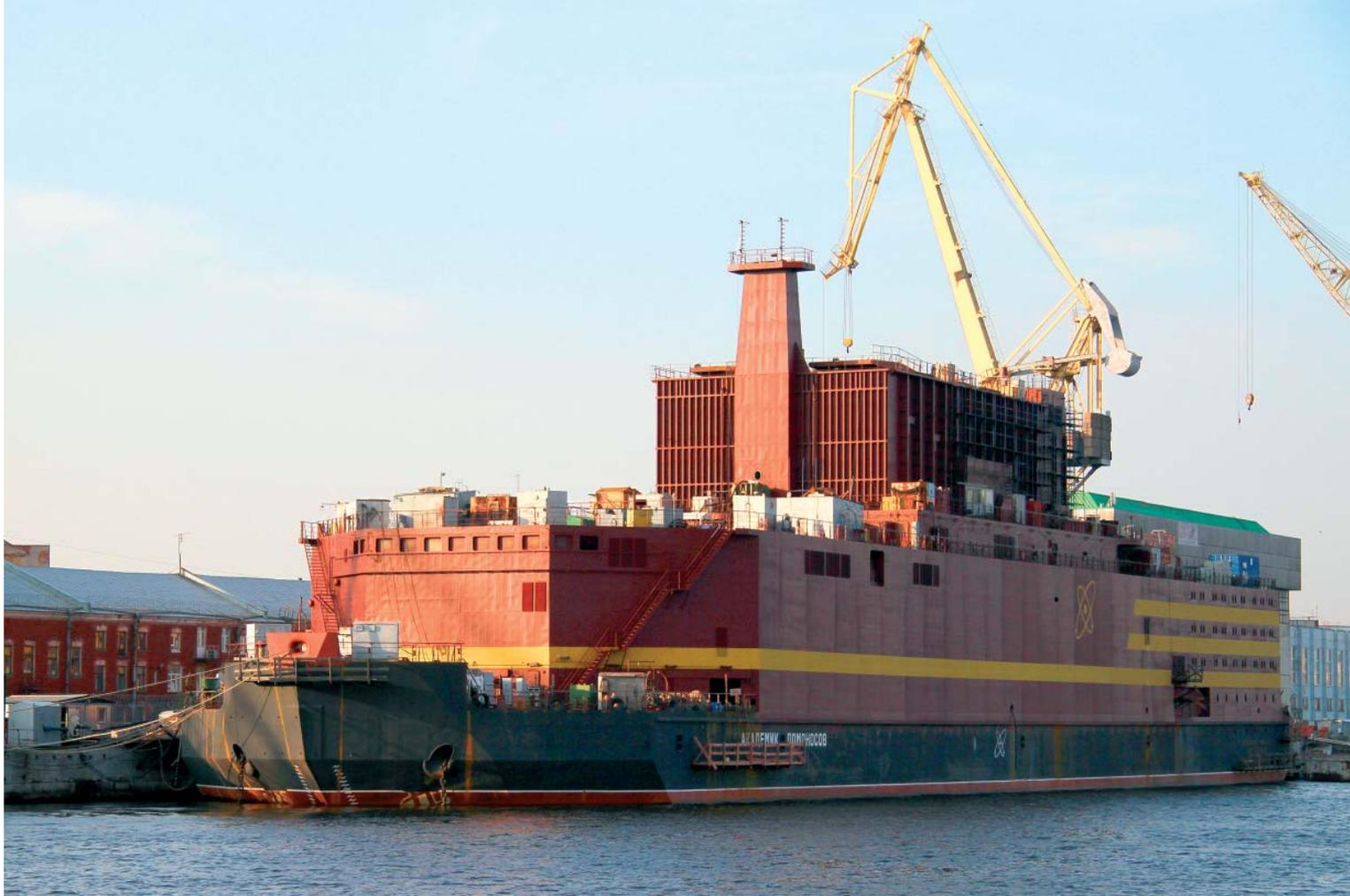
Плановый срок окончания швартовных испытаний первого в мире плавучего энергетического блока (ПЭБ) «Академик Ломоносов» – 30 октября 2017 года. Цель швартовных испытаний – проверка работоспособности и соответствия проектным характеристикам оборудования и систем плавучего энергоблока.
