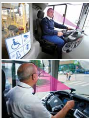
Система контроля присутствия и усталости водителя «Антисон»
